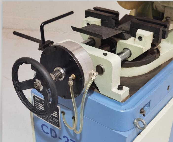
Sistema neumático de sujeción
